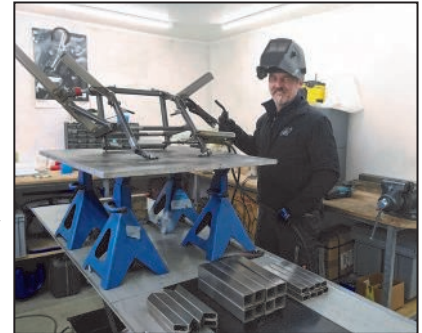
Neukonstruktion des Rahmens
